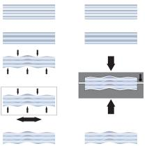
Figure 55. Cold and hot bending (de Vries & van Es, 2017)
