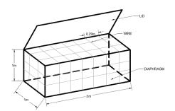
Figure 10-9. Box gabion dimensions
