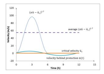
Figure 10-13.Relevant scouring parameter
