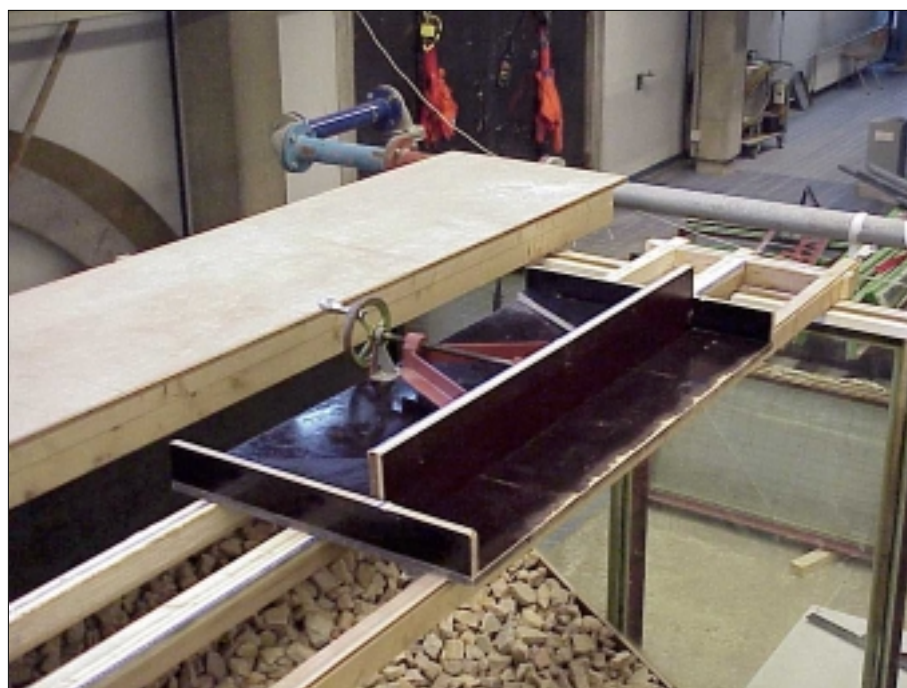
Foto A-8 Model zijschuifstorter op meetbalk
