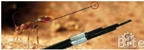
Ovipositor Needle II, ontwikkeld in 2016-2019, diameters variërend van 1,2 mm tot 0,4 mm.
