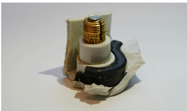
Figure 55: Metal inserts in PC (Tubular)
