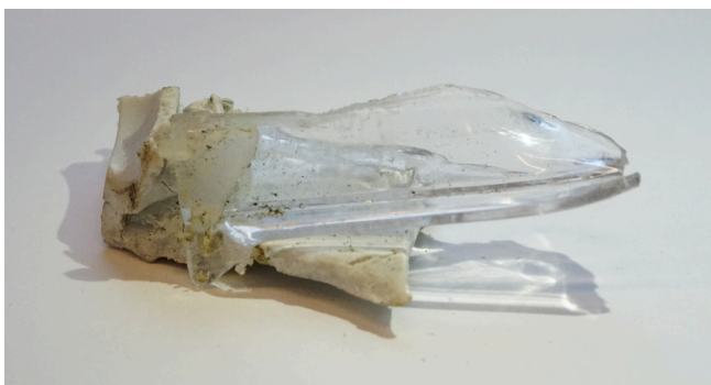
Figure 56: Glued PC parts (Tubular)
