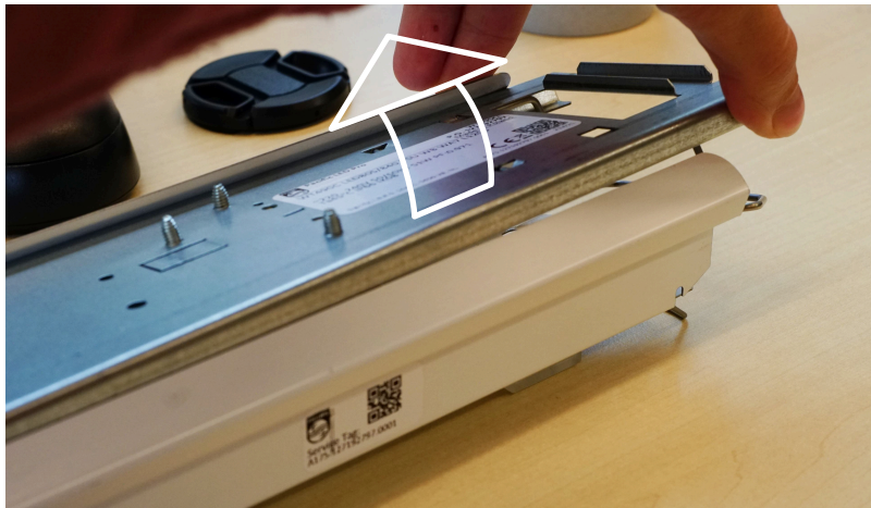
Figure 28: Pulling the gear tray out (Tubular)
