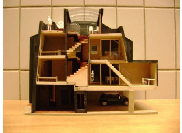
Figuur 2.14: Totaalbeeld (doorsnede) rechterzijde woning. Let op het centrale trappenhuis met gemetselde wenteltrap. (Bron: auteur)
