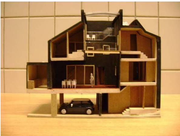
Figuur 2.13: Totaalbeeld (doorsnede) linkerzijde woning. Let op de L-vormige centrale woonruimte (met 'weergang') en vide. (Bron: auteur)
