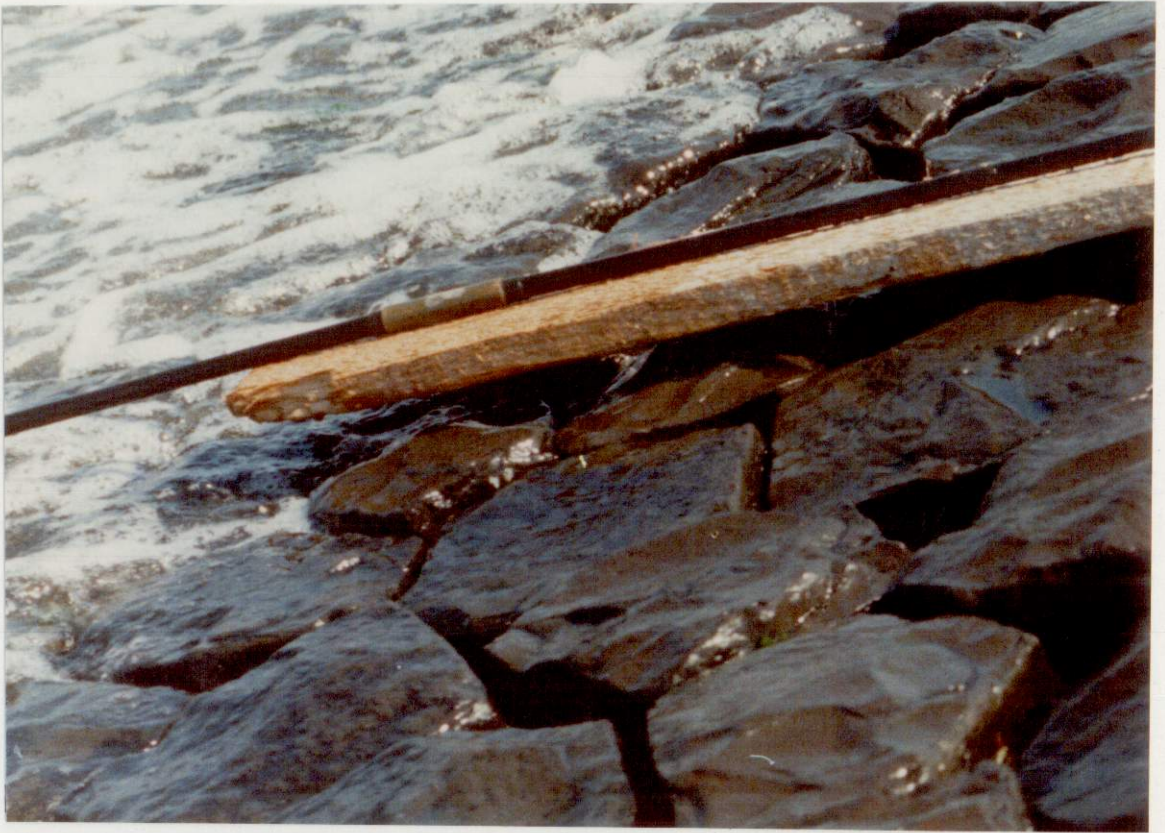
Foto 4 Detail meetkabel met electrode.
