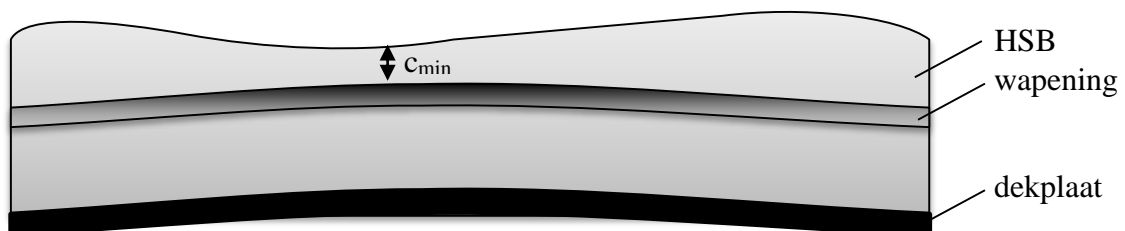
Figuur 7 Moeilijkheid bij het behalen van de dekking
