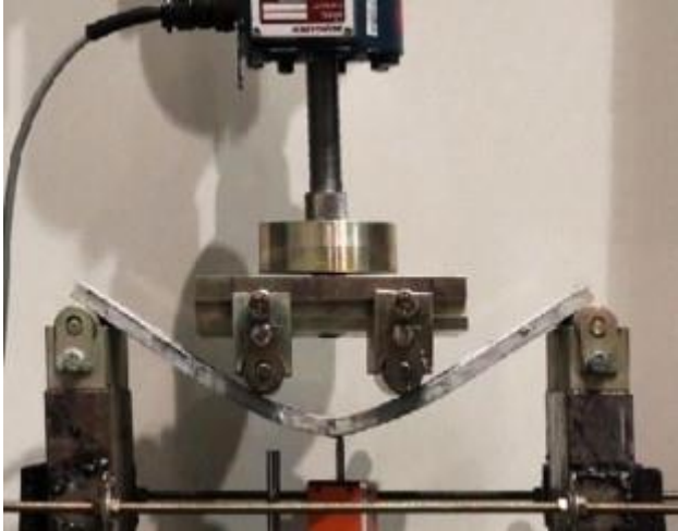
Figuur 19 Door de grote krommingen die ECC kan ondergaan, buigt een dunne ECC plaat vele centimeters door
