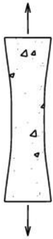
Figuur 52 Defecten op willekeurige locaties zorgen in een proefstuk voor plaatselijke spanningsconcentraties
