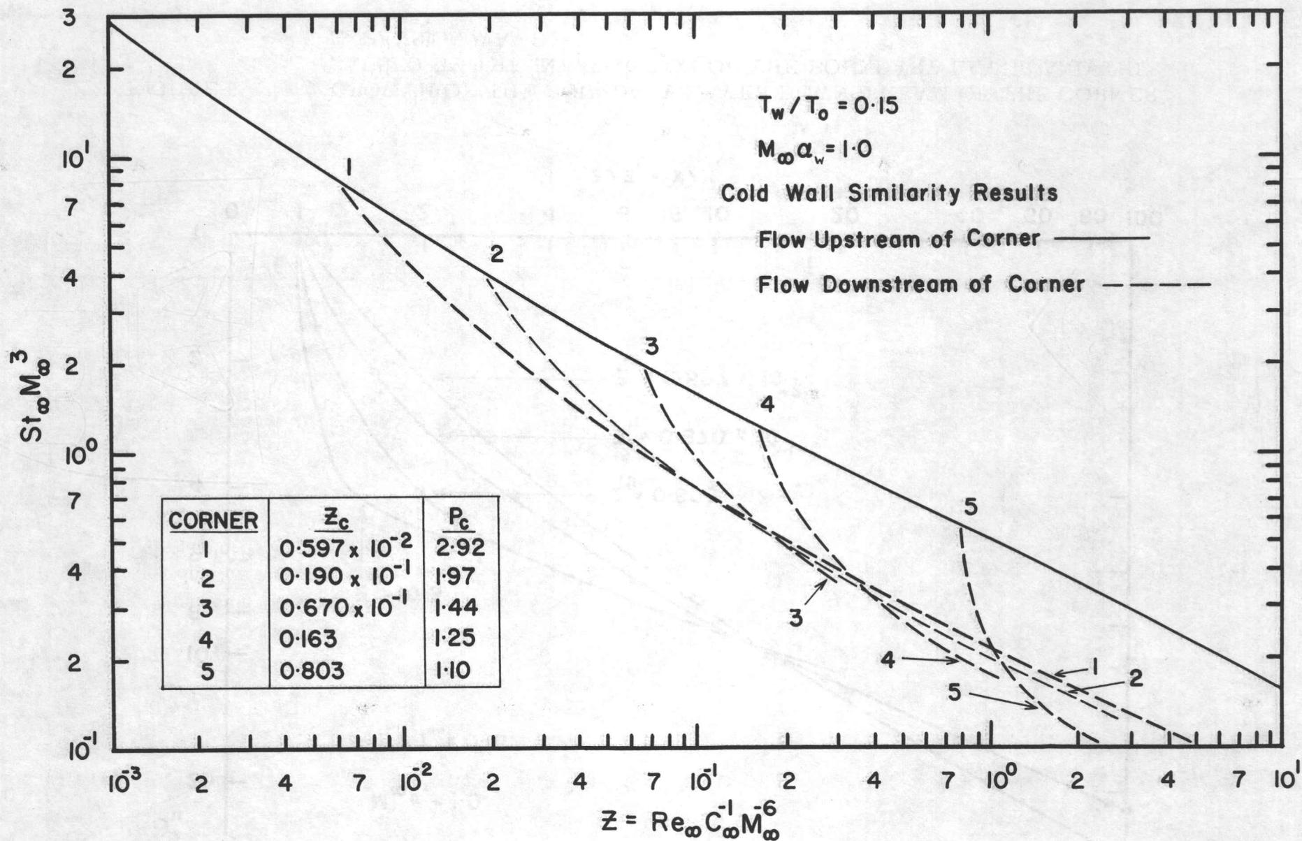
FIGURE 5: HEAT TRANSFER DISTRIBUTION DOWNSTREAM OF AN EXPANSION CORNER IN HYPERSONIC FLOW FOR  $M_\infty \alpha_w = 1.0$  and  $T_w/T_o = 0.15$
