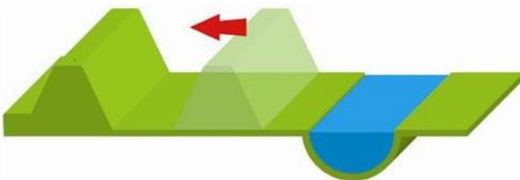
Figure 5-2: Dike repositioning (Ruimte voor de Rivier, 2014)
