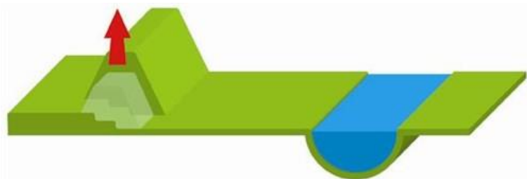
Figure 5-4: Dike improvement (Ruimte voor de Rivier, 2014)
