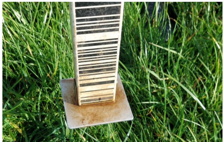
Figuur 5. Een vierkant plaatje aan de onderkant van een baak.
