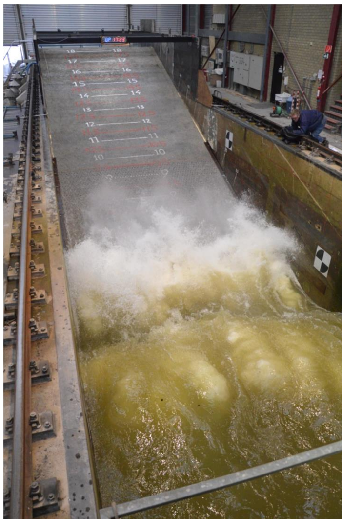
Figuur 4.1 Beproeven van C-Star zuilen in de Deltagoot (Tijdens Proef 08)
