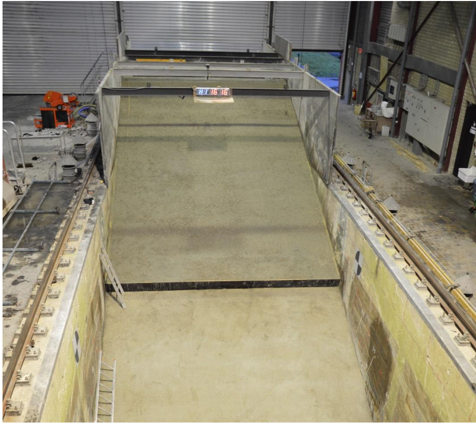
a) Opbouw model: afwerken van talud (3)
