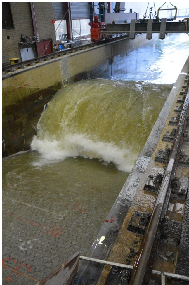
Figuur 2.1 Golfaanval op steenzetting van het type C-Star in de Deltagoot
