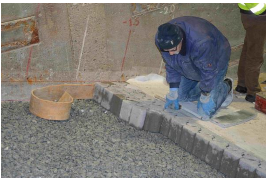
Figuur 3.2 Plaatsing van C-Star in de Deltagoot (2015)
