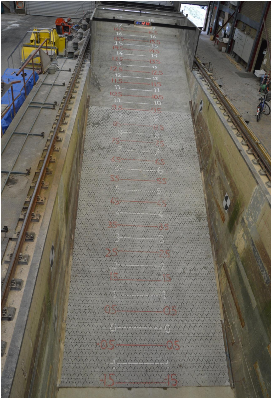
a) Opbouw model: ingewassen steenzetting voor Proef 1
