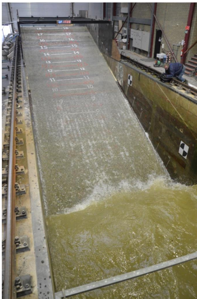
Figuur 4.2 Tijdens de golfneerloop is te zien dat er water uit de bekleding komt
