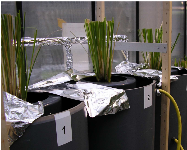
figuur 8.3: de opstelling van vetiver gras met een verschillende waterstand
