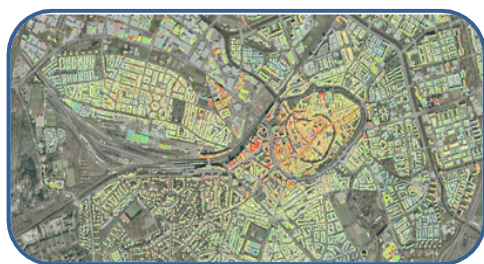
Figuur 30 Warmtescan (033 Energie, 2012c)
