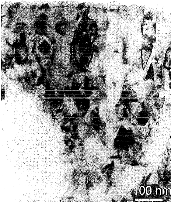
figuur 8: TEM-opname in doorsnede van een laag die bij 70 °C is opgedampt. Op de foto zijn zowel de oorspronkelijke kolomstructuur als een uitgegroeid kristalliet zichtbaar.
