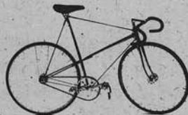
De spanfiets van de la Haye (1981), kruisframe gecombineerd met drieboeken, zoals bij de 'Psycho'
