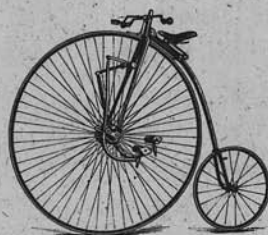
Singer's 'Xtraordinary' uit 1879 heeft een besboom-aangedreven voorwiel van ± Ø 1m
