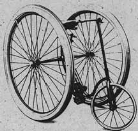
De drierieler die Dunlop in 1887 voorzag van luchtbanden
