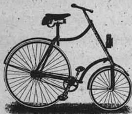
De 'Humber Dwarf Safety' uit 1885 is afgeleid van de 'Cripper' drierieler
