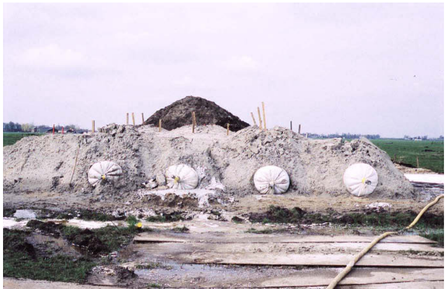
Figuur 3 Vooraanzicht van proef met vullen van expanders in zandterp.
