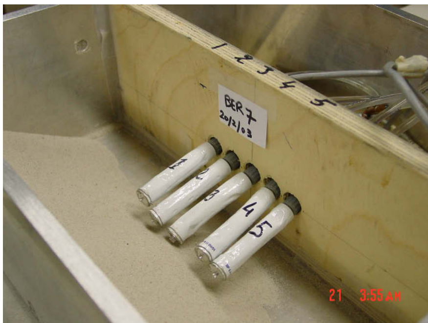
Figuur 15 Centrifugeproef met 5 expanders, na ontgraving.
