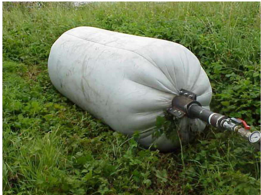
Figuur 4 Gevulde expander met klemconstructie.
