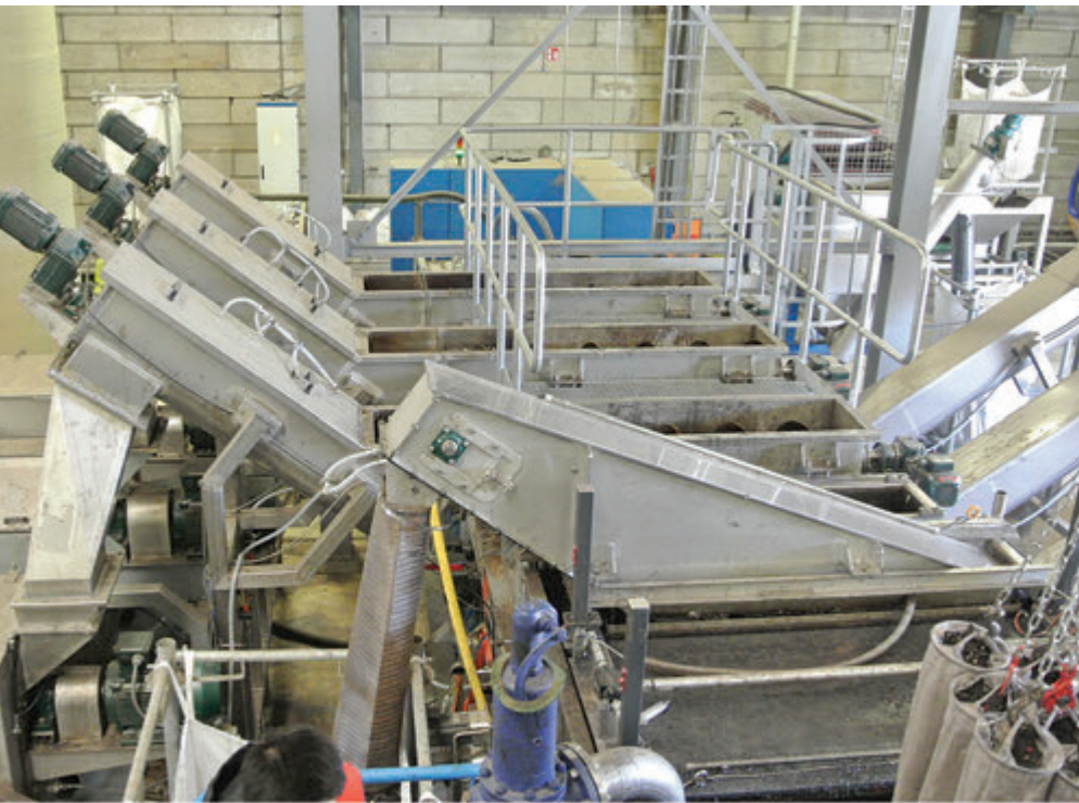
FIG. 1 Links: MDS technologie om flakes in één stap in vijf soorten te scheiden. Rechts: het principe van de scheiding in het laboratorium voor verschillende plastics (en metalen).
