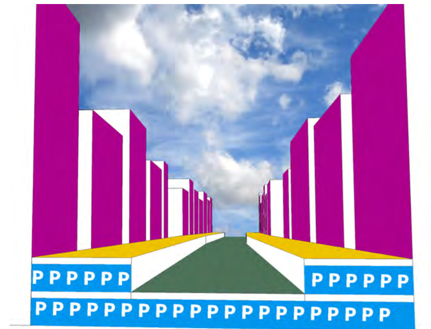
Figuur 11.4: Doorsnede Kruithuisboulevard. Op de gele plint is ruimte voor fietsers en voetgangers, over het donkergroene deel loopt de provinciale weg en daaronder bevindt zich parkeerruimte.
