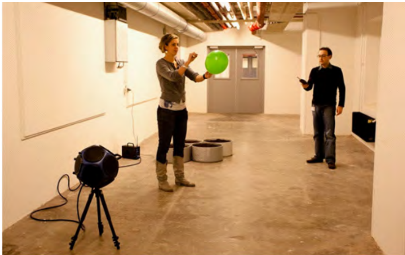
Figuur 5.4 De ballontest in de meetruimte
