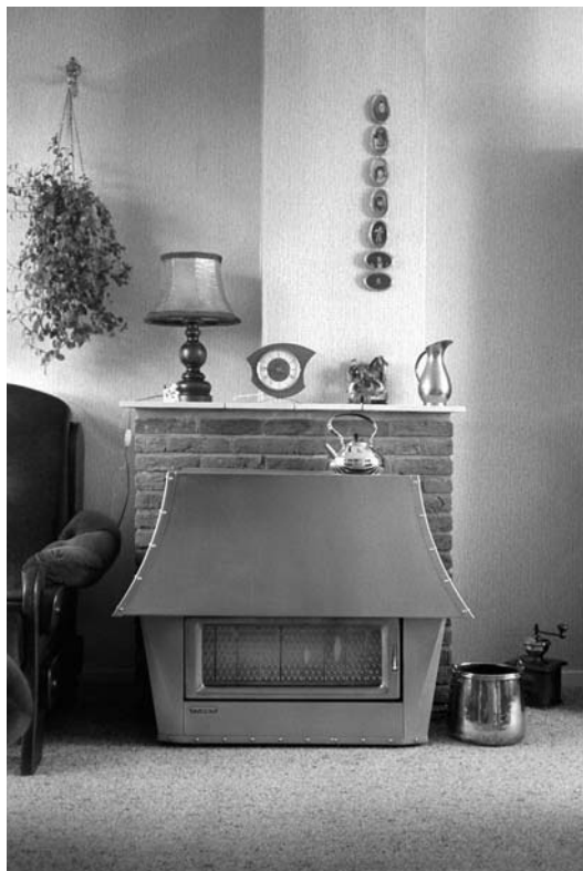
Bij het ombouwen naar cv vervalt de afzuigfunctie van het schoorsteenkanaal
