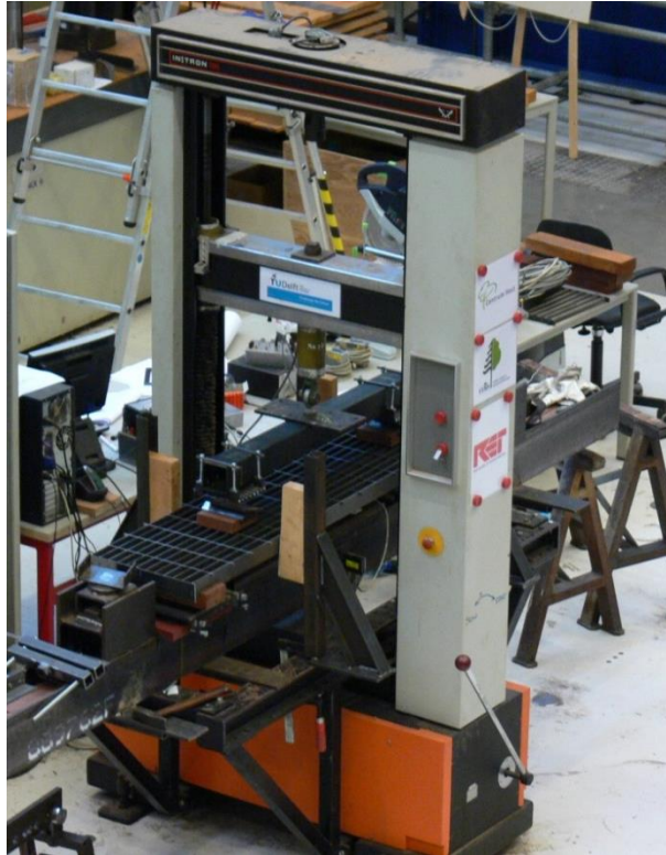
Figuur 41: Weergave gebruikte drukbank met daarin een proefstuk
