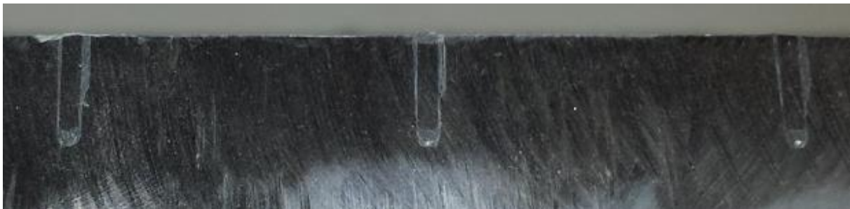
Figuur 9: Doorsnede van de persverbinding na het verzinken
