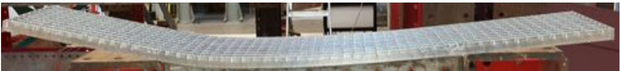
Figuur 57: Blijvende vervorming na ontlasten van een verzinkt proefstuk van proefserie 1B
