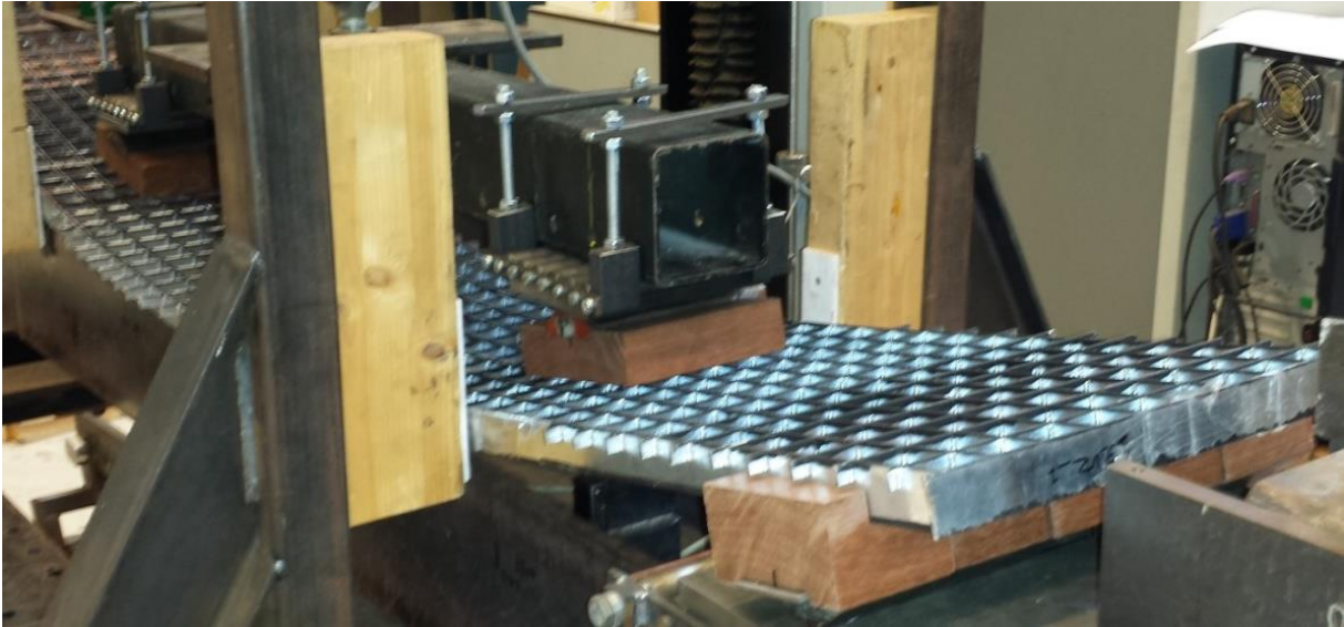
Figuur 56: Vervorming van een verzinkt proefstuk van proefserie 1B t.g.v. een belasting 7 kN
