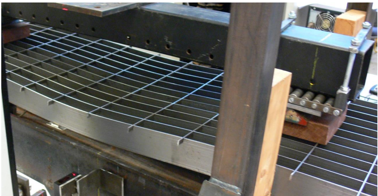
Figuur 63: Globale-kipinstabiliteit in de niet-verzinkte proefstukken van proefserie 2B
