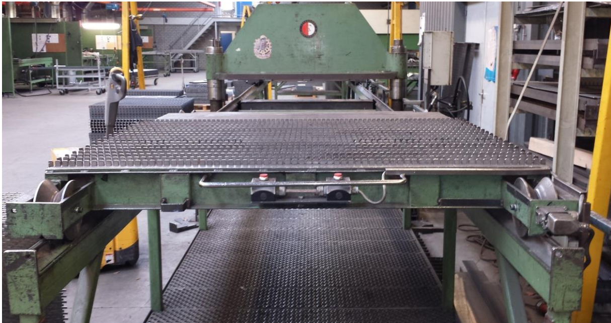
Figuur 17: Niet volledige geautomatiseerd, ouder type machine, voor het persen van de persverbinding (zonder draagstaven)
