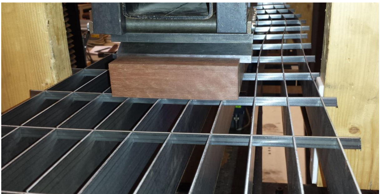
Figuur 60: Bezwijkvorm niet-verzinkt proefstuk proefserie 2A
