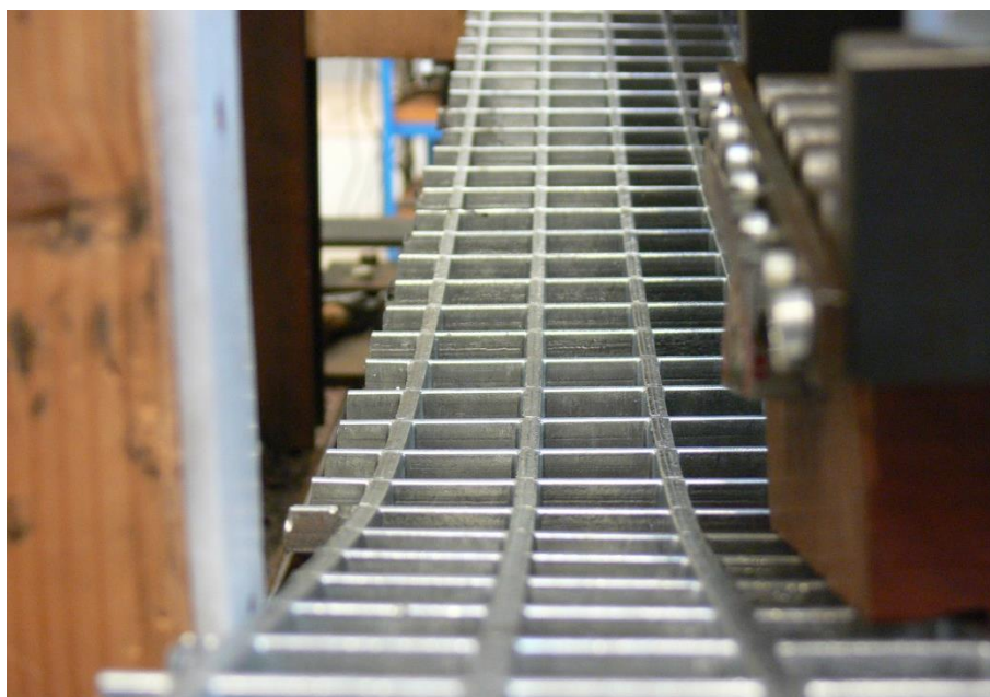
Figuur 53: Kromming draagstaven in proefserie 1A
