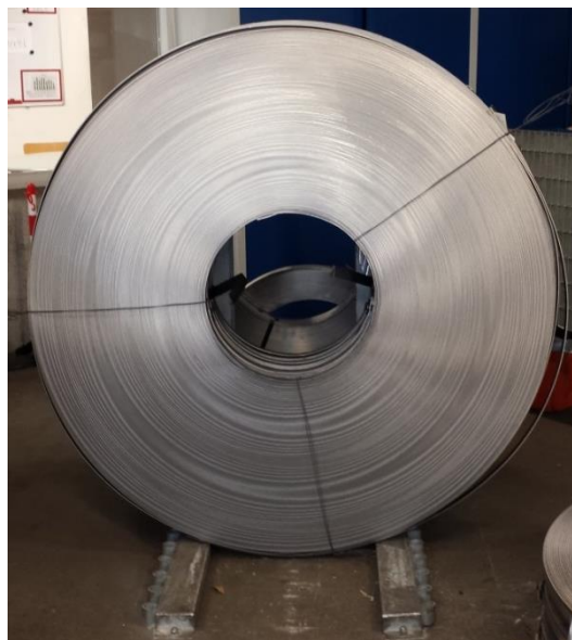
Figuur 15: Op draagstaafhoogte gesneden plaatstaal voor de productie van de draagstaven
