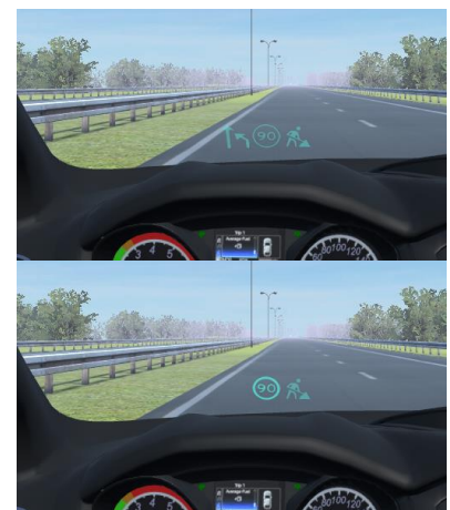
Figuur 2. HUD waarschuwingen bij een werkvak. Boven: normal. Onder: snelheidsoverschrijding.
