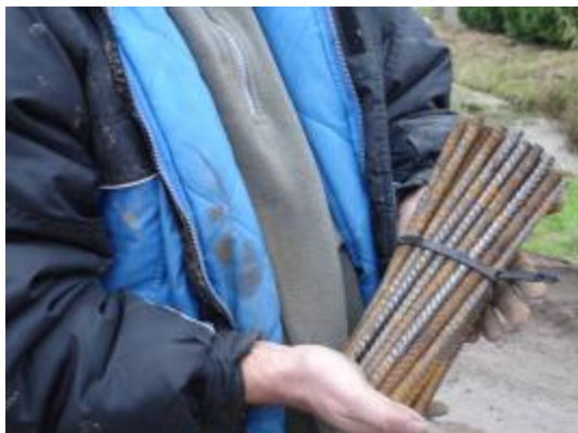
Figuur 4.6 Links: stalen pinnen die in de houten palen worden geslagen, rechts: aanbrengen stalen pinnen.
