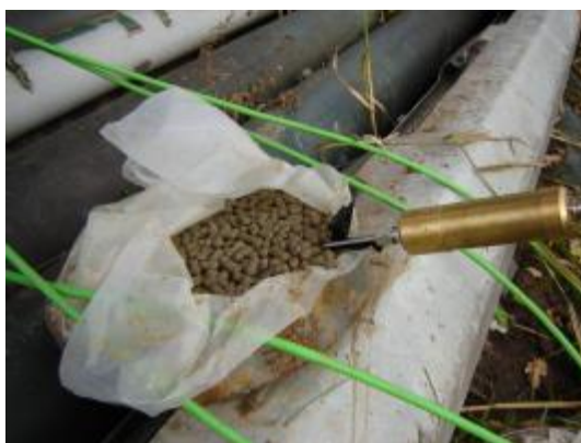
Figuur 3.2 Links: Total Pressure Cell is ingebouwd in constructie met doorsnede 29,4 cm, rechts: installatie van Total Pressure Cell bovenop het geotextiel
