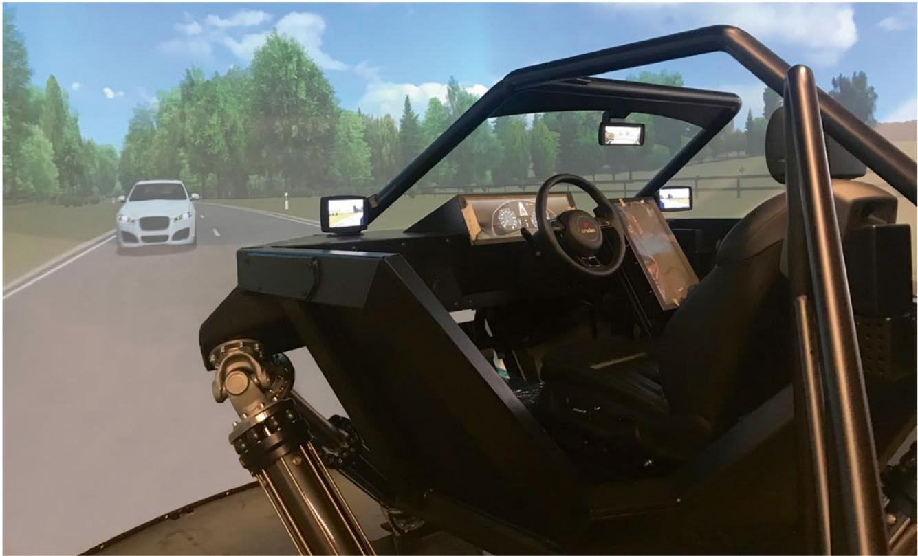
**BILD 1** Der 6DoF-Fahrsimulator mit Bewegungssystem von Cruden mit funktionierenden Seiten- und Rückspiegeln und 210°-Sichtbereich-Projektionssystem (© Cruden)
