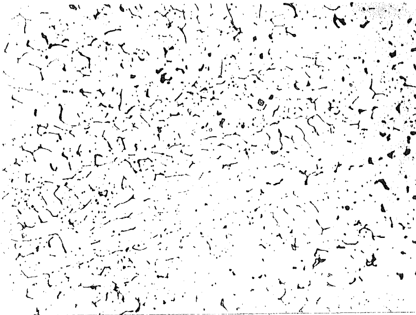
Foto 24. Austenitisch lasmetaal met 6,2 % ferriet, \sigma = 3,8 . Las 2 gelegd op 1740 (0,59 %C). Vergroting: 500x; etsmiddel: 25% \text{HNO}_3 , 25% \text{HCl} , 50% ethylalcohol.
