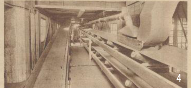
Links een zakkentransportband; rechts twee transportbanden, welke per uur 250 ton graan in- en uitbrengen.
