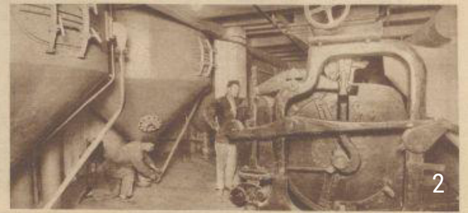
Links een aantal waterfilters, waarin de lucht, voordat ze door de pompen gaat, wordt gezuiverd. Rechts een weegschaal, die bij elke kieping 2250 K.G. graan in- of uitbrengt. Per uur kiept deze schaal automatisch 270.000 K.G. graan.
