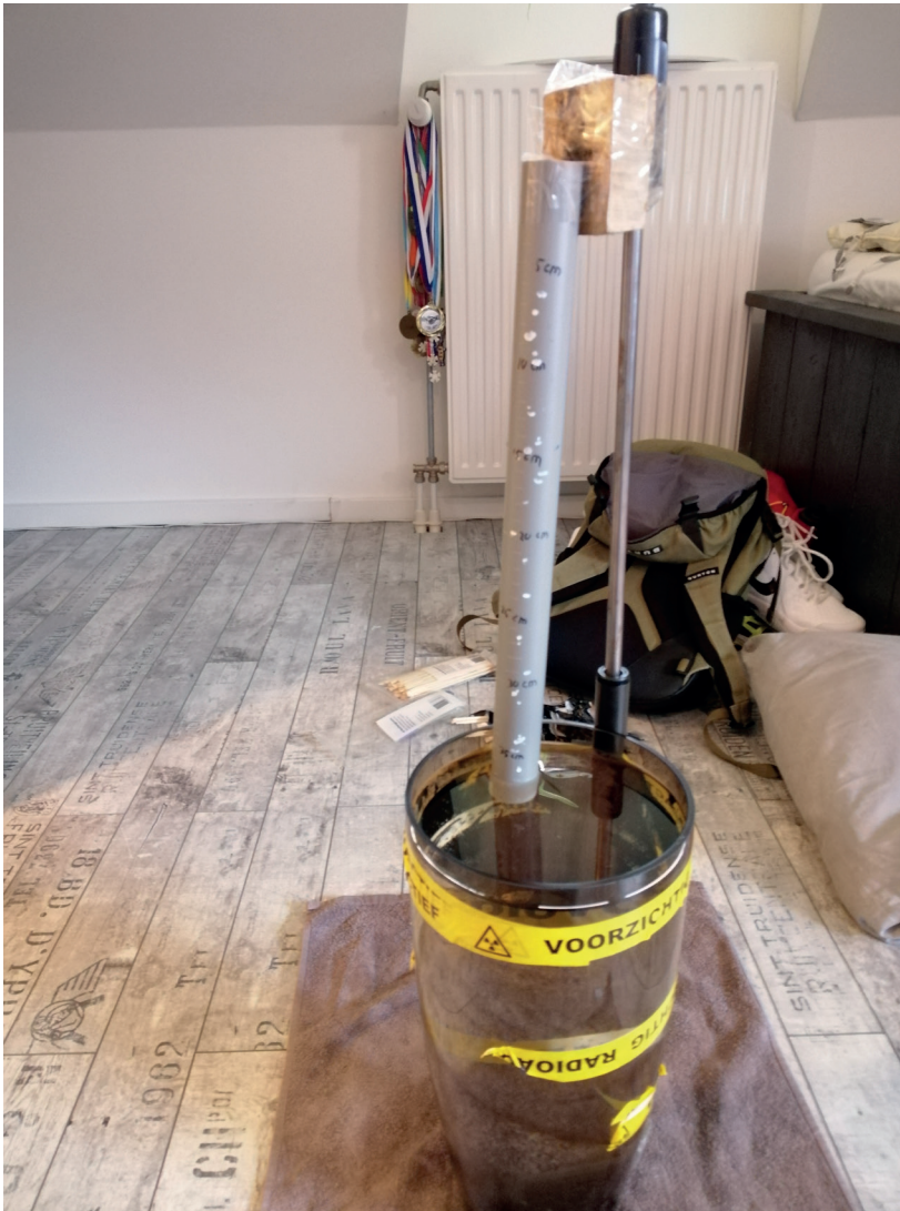
Figuur 2. De opstelling zoals gebruikt door student Tim Levert, waarbij de lengte van de pijp werd aangepast door deze steeds verder in de bak met water te steken.
