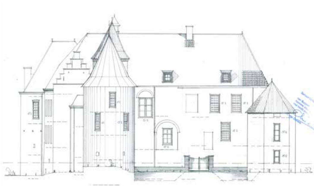
FIGUUR 4.11 Een eerste voorstel voor de herbouw van de voorgevel, inclusief de herbouw van de weermuur en de zeshoekige toren, september 1994/mei 2001
