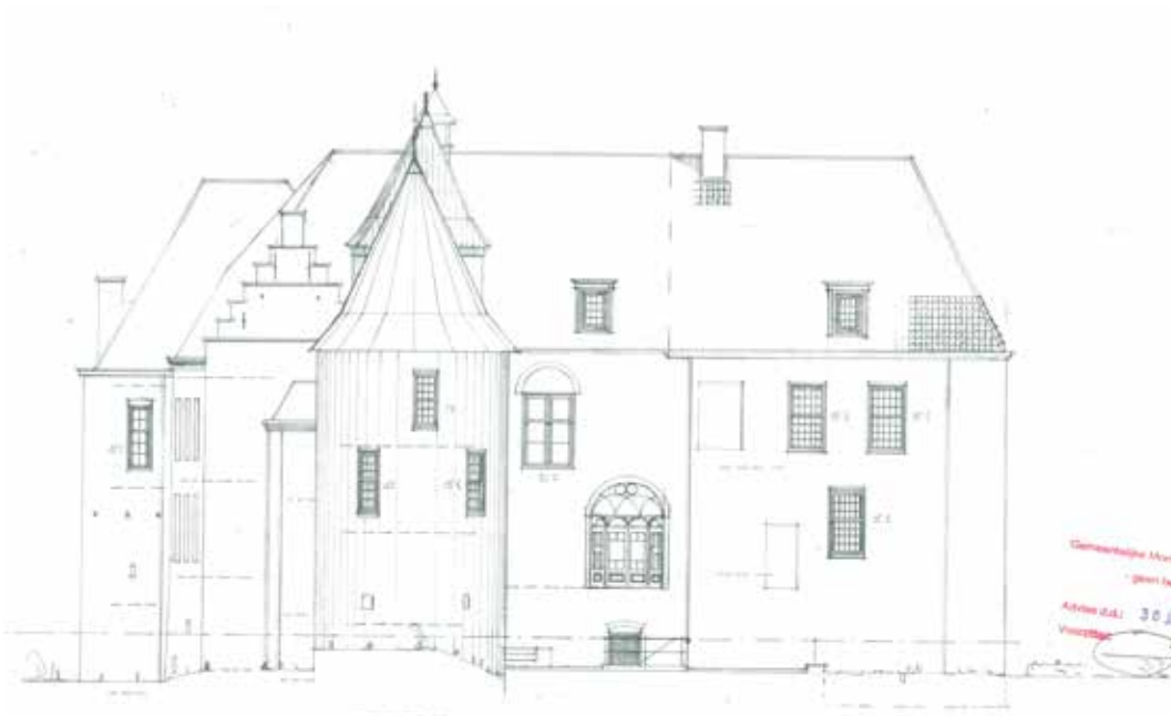
FIGUUR 4.12 Het uiteindelijke ontwerp voor de herbouw van de voorgevel, inmiddels zonder de herbouw van de weermuur en de zeshoekige toren, november 2002
