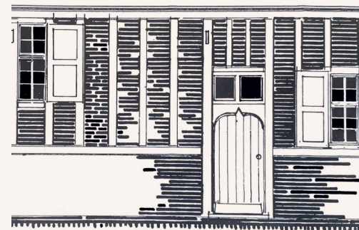
Figure 2.12: Farmers house with brick infill in half timbered technique (Groot Leysele, 1530) (Trefois, Van vakwerk tot baksteenbouw , 1979).
