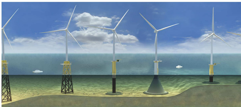
Figuur 1. Verschillende offshore funderingen (Redwave, 2014)
