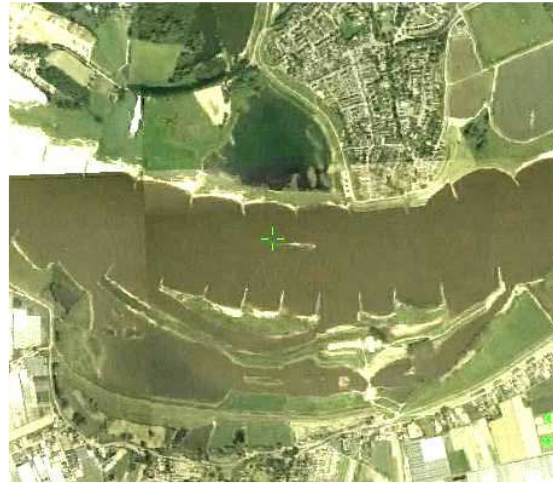
1.1b: Splitsingspunt op kleine schaal: nevengeulenstelsel in de Waal bij Gameren.
