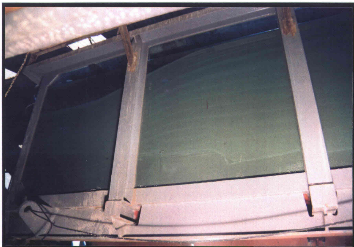
foto D6: Bezonden zandlaag na schottenkerend beladen Sedimentatiesystemen voor sleeppopperzuigers 2
