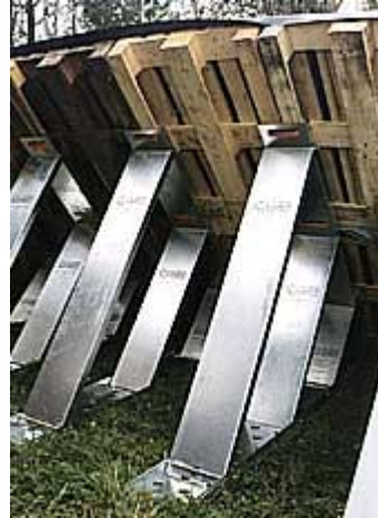
Figuur 4.2 Een Aquabarrier waarbij er 2 pallets boven elkaar worden gebruikt, de metalen steunen op een grasveld zijn echter erg gevoelig voor wegglijden.
