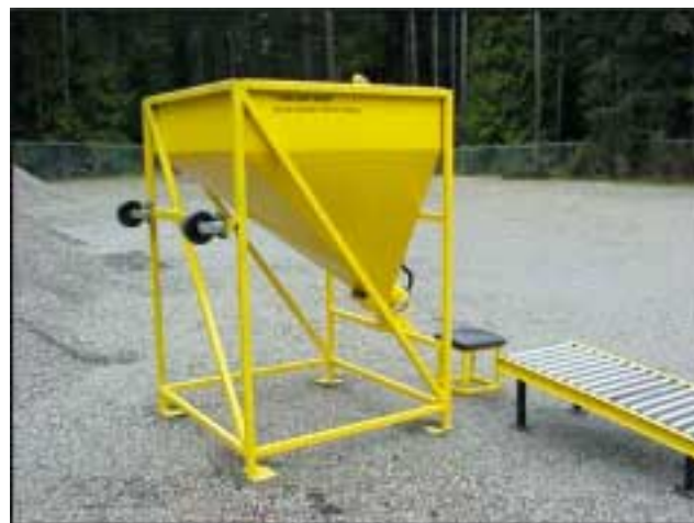
Figuur 3.4 De "Quicksander", "GoBagger", "Sandbagger" en "Li'l Bagger" zijn systemen waarmee het vullen van zandzakken kan worden versneld.
