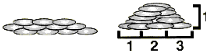
Figuur 3.10 De zandzakken dienen "halfsteens" te worden neergelegd. De breedte van de voet van de zandzakdijk moet tenminste 3 maal de hoogte zijn.
