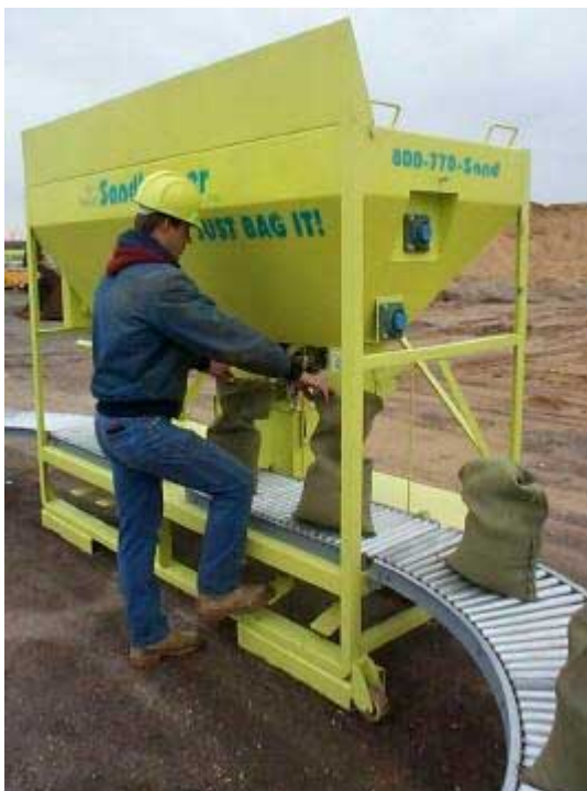
Figuur 3.4 De "Quicksander", "GoBagger", "Sandbagger" en "Li'l Bagger" zijn systemen waarmee het vullen van zandzakken kan worden versneld.
