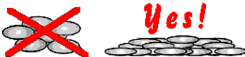
Figuur 3.8 De zandzakken niet los op elkaar gooien, maar goed aanstampen voor een betere onderlinge aansluiting.
