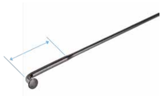
Afbeelding 2 Een 'double-butt' spaak – vanwege spanningsconcentraties en vermoeiing.
