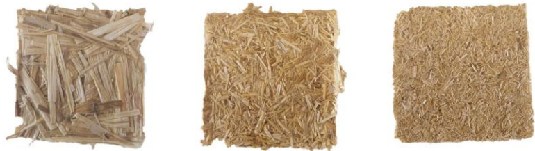
Soy protein binder 8 g soy - 12 ml water - 0.4 g lime 50 mm fibers 15 g Soy protein binder 8 g soy - 12 ml water - 0.4 g lime 15 mm fibers 15 g Soy protein binder 8 g soy - 12 ml water - 0.4 g lime 5 mm fibers 15 g
