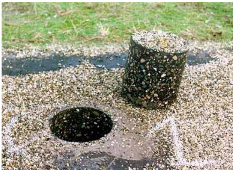
Figuur B3.2 Boorkern uit een bekleding van waterbouwasfaltbeton
