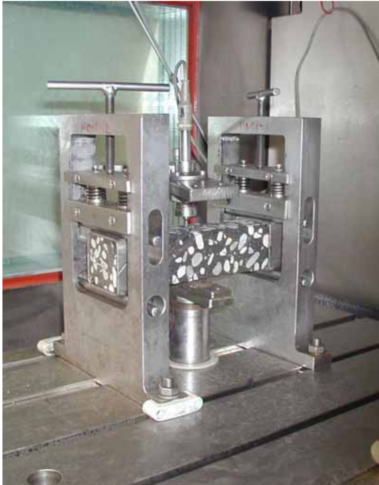
Figuur B3.5 Proefopstelling van de driepunts-buigproef (foto: NPC)
