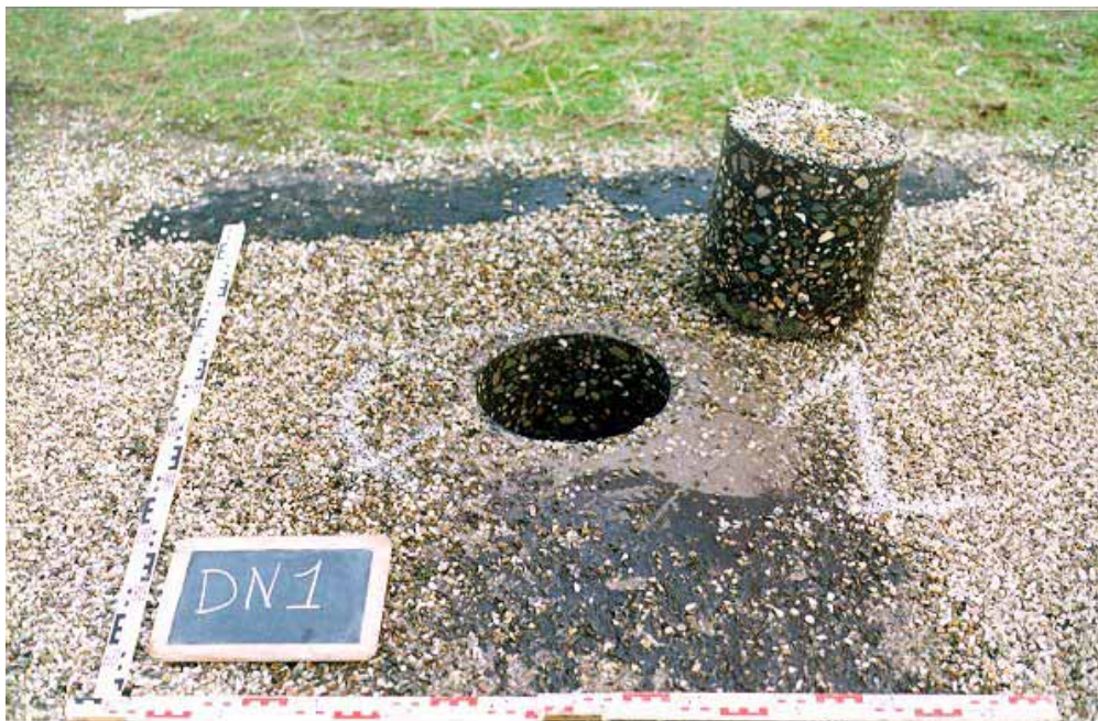
Figuur A1.1 Boorkern uit een waterbouwasfaltbetonbekleding (Damaanzet Noordland, 1991)
