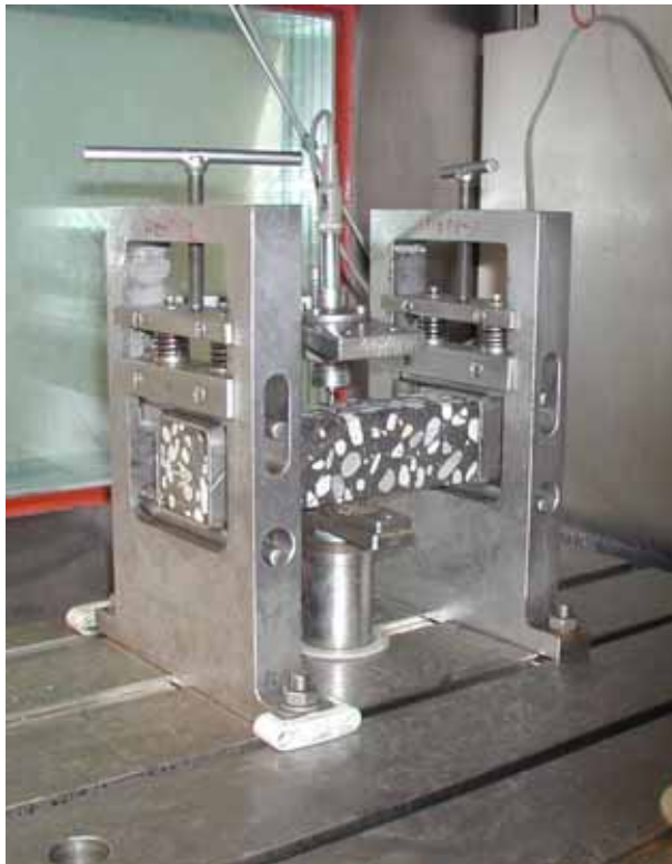
Figuur A2.21 Opstelling Driepuntsbuigproef
