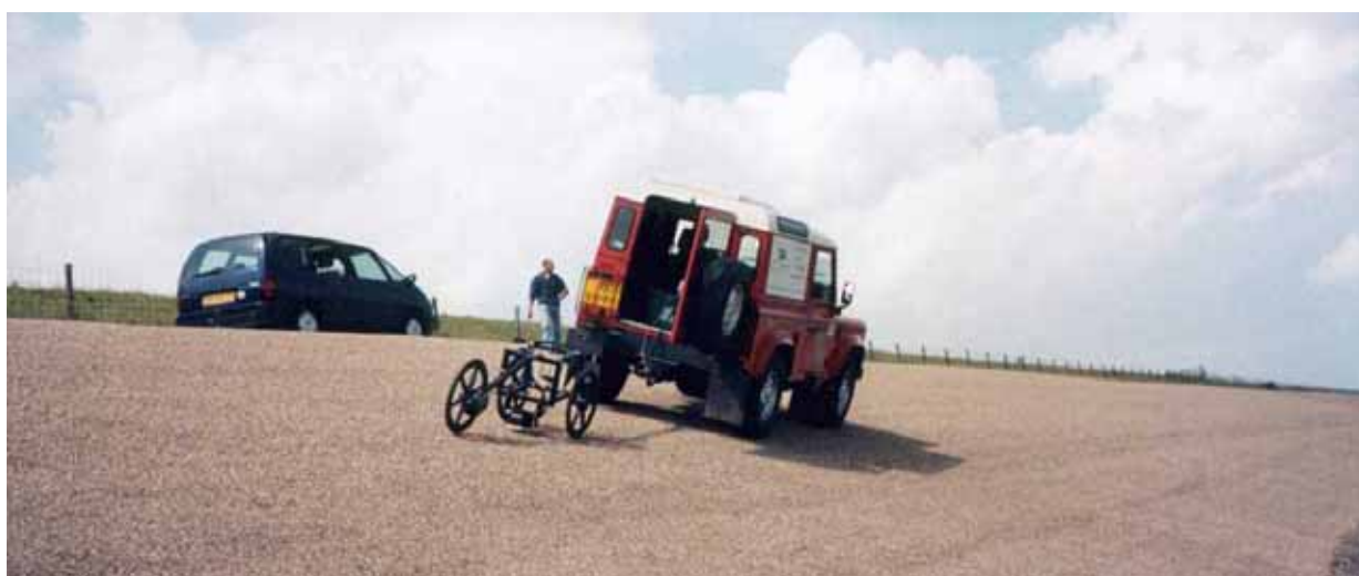
Figuur A2.1 Radarmeting op de asfaltbetonbekleding van Texel
