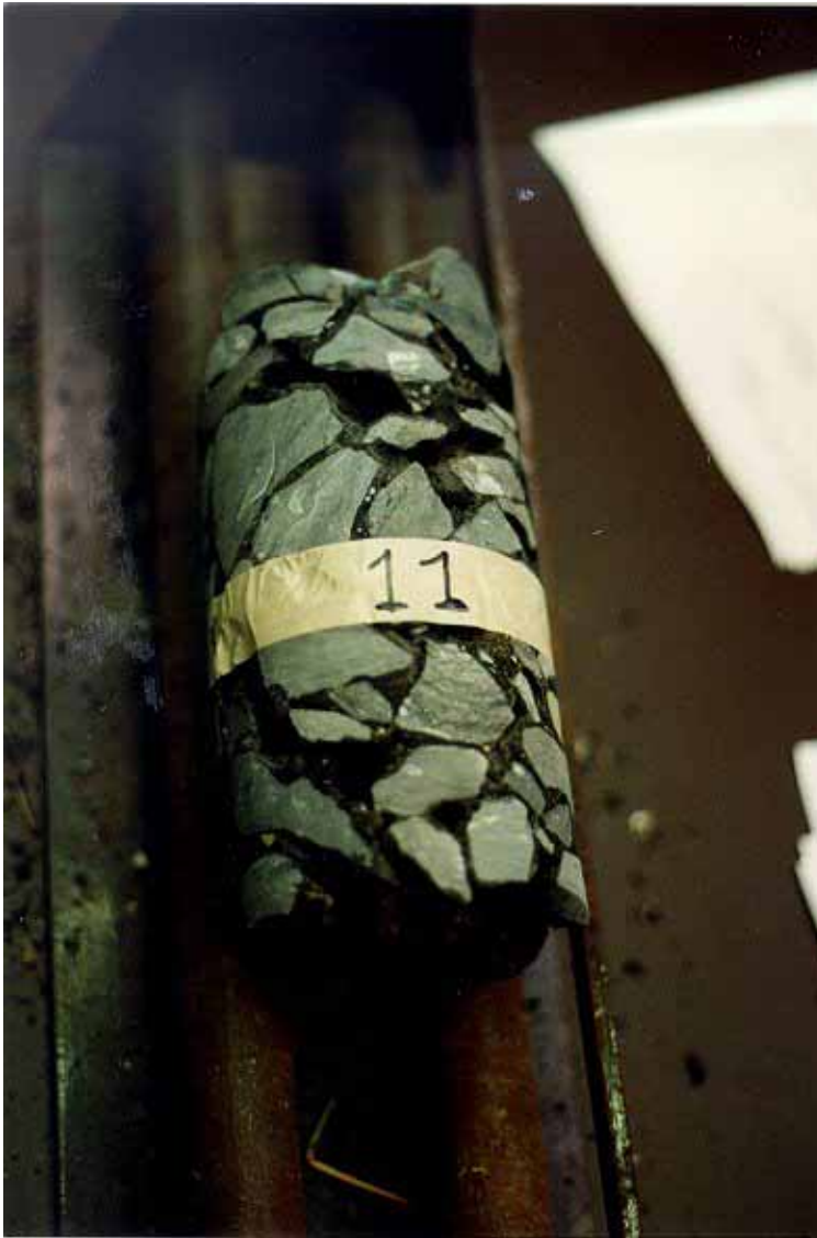
Figuur A2.1 Boorkern van open steenasfalt (Noordland, 1991)
