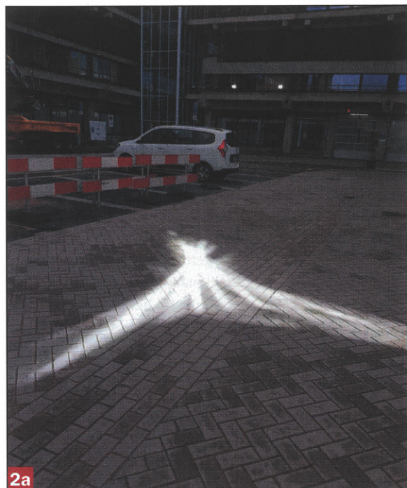
Foto brandpunt en IR-meting door opdrachtgever
