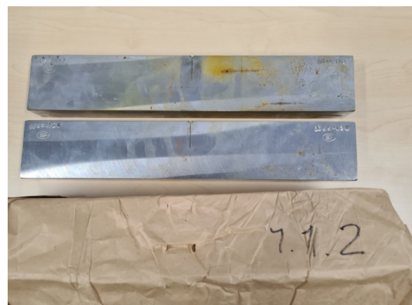
(d) Prepared SENB specimens before fatigue testing.
