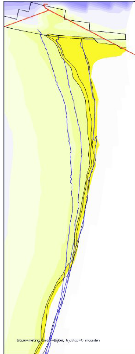
Figuur 4-10 Berekende (zwart) en gemeten (blauw) NAP 0 m lijnen voor 1968, 1978 en 1986 een terugkoppelingstijdstap van 6 maanden. Deze berekening is met de oude bodem gedaan wat betekent dat de duinhoogte hoger is waardoor de snelheid waarmee het strand naar voren komt lager is.
