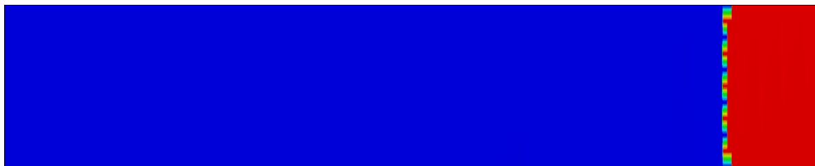
(d) Final delamination after 5e7 cycles.
