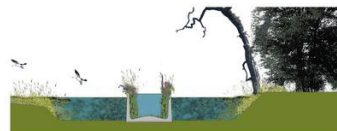
4. Beekprofiel in de monding: - conformiteit van pool waterlijn in brak watermilieu - schanskorven met puij aan weerszijden van de beek t.b.v. plantengroei en migratie fauna
