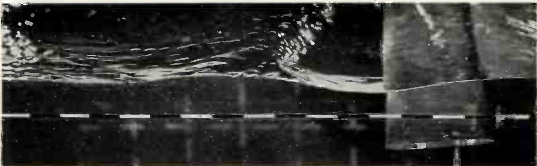
Bild 23 Ebene Strömung an einer Platte; v = 0,63 \text{ m/s} , überkritisch; \tilde{\sigma}_h = 0,90 ; \tilde{\sigma}_h^{**} = 1,20
