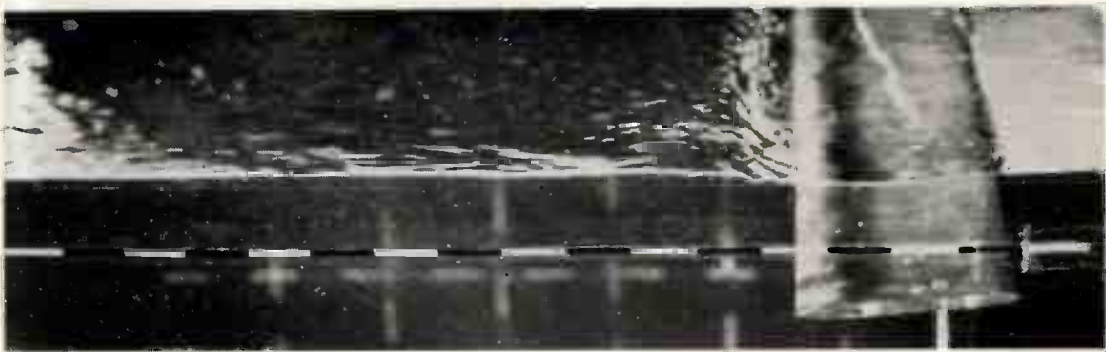
Bild 22 Ebene Strömung an einer Platte; v = 0,5 \text{ m/s} , kritisch; \tilde{\sigma}_h = 0,71 ; \tilde{\sigma}_h^{**} = 0,96
