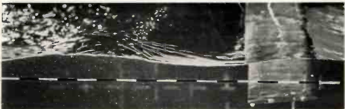
Bild 24 Ebene Strömung an einer Platte; v = 0,75 \text{ m/s} , überkritisch; \tilde{\sigma}_h = 1,07 ; \tilde{\sigma}_h^{**} = 1,43
