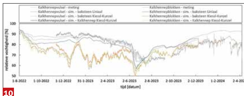
Meetresultaten voor de zuidwand (Melk S) versus WUFI simulatieresultaten met voor de baksteen vochttransporteigenschappen op basis van de liniaal methode en de vereenvoudigde Kieβl-Künzel methode (A = kalkhennepblokken, B = kalkhennepvulsel).
