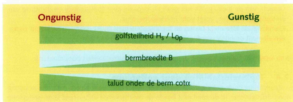
Figuur 2.6 Aanvullende parameters steenzetting op berm
