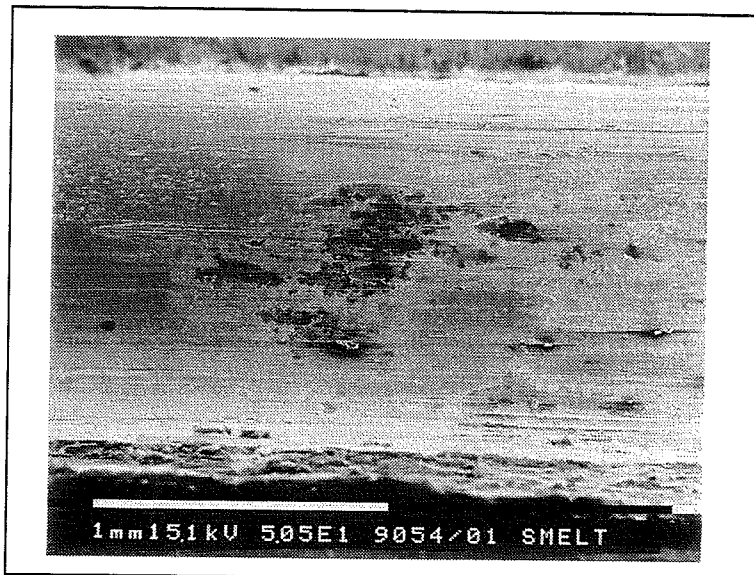
Foto 4.35: beschadiging van het oppervlakte van het kanaal in de contactbuis, 50 x vergroot.
