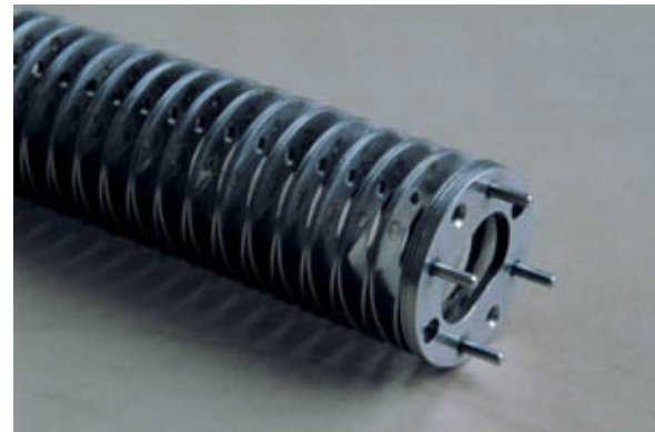
De veer die Breedveld ontwikkelde voor de endoscooptip bestaat uit plaatjes verenstaal die aan elkaar zijn gepuntlast. De veer heeft een asymmetrische buigstijfheid en een bijzonder grote torsiestijfheid. De gaatjes zijn voor geleiding van de trekdraden.
