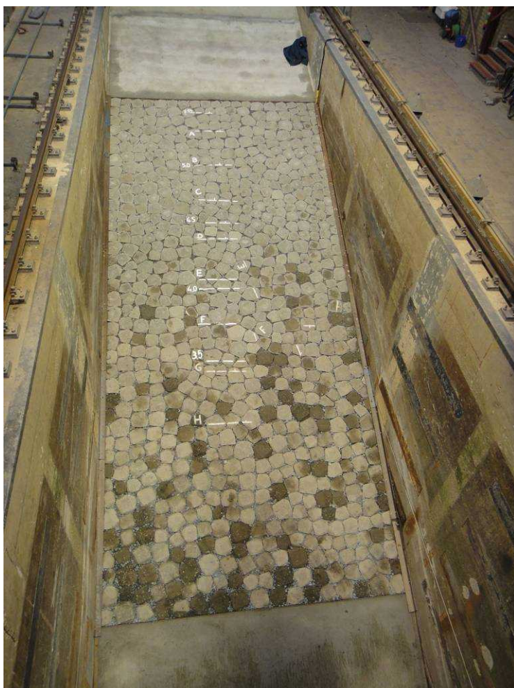
b) Hersteld profiel (voor proef 2)
