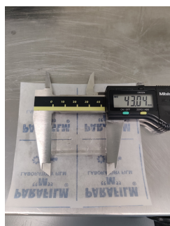
(d) Swollen 40mm rectangular slab length.
