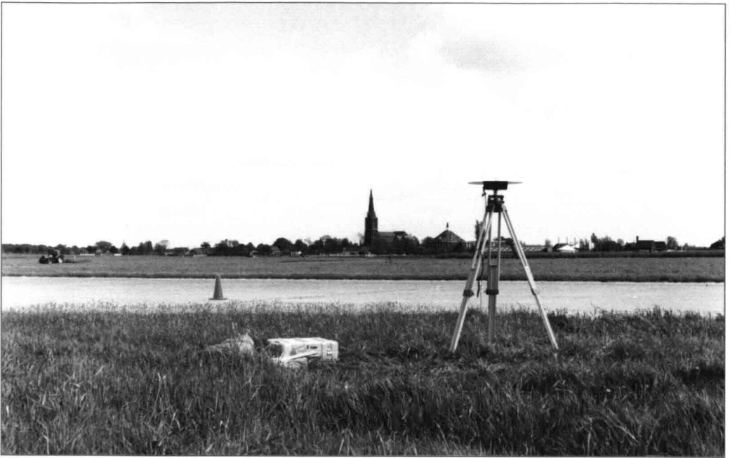
GPS-antenne op een statief tijdens metingen in het veld. Het doosje op de voorgrond bevat de GPS-ontvanger. De kerktoren op de achtergrond wordt daardoor overbodig als referentie voor meetkundige doeleinden.
