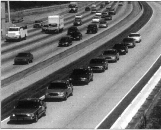
Peloton rijden tijdens een demonstratie in San Diego in augustus 1997. Magneten op regelmatige afstand in het wegdek zorgen voor de geleiding van de auto's.
