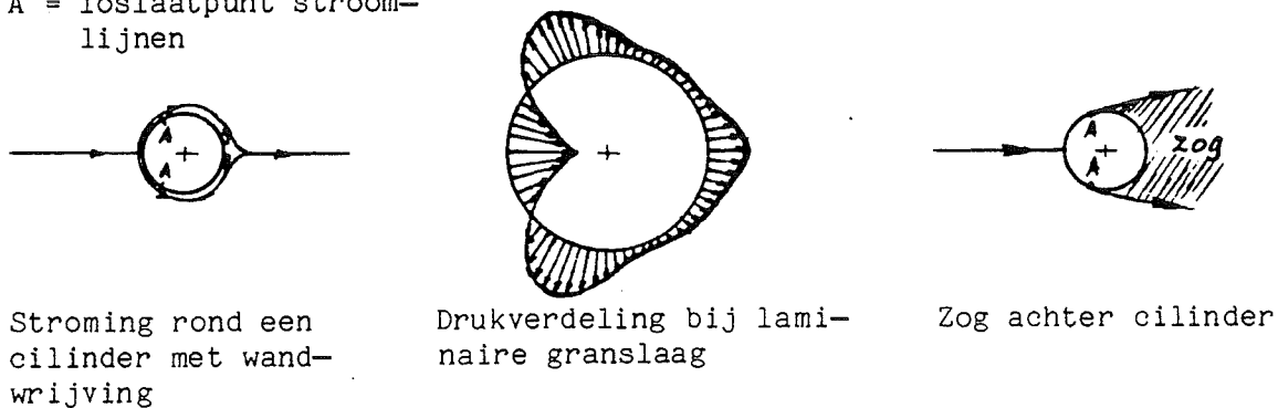
Fig 150. Laminaire stroming rond een cilinder
